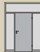
1-WI2-OLI (1-flügelig, 2 Stillstände, 1 Oberlicht) 1-WI2-OLI (single leaf, 2 standstill elements, 1 fanlight)
