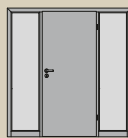
1-WI2 (1-flügelig, 2 Stillstände) 1-WI2 (single leaf, 2 standstill elements)
