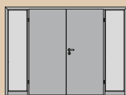
2-WI2 (2-flügelig, 2 Stillstände) 2-WI2 (double leaf, 2 standstill elements)
