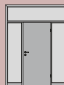
1-WI2-OLI (1-flügelig, 2 Stillstände, 1 Oberlicht) 1-WI2-OLI (single leaf, 2 standstill elements, 1 fanlight)
